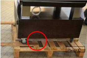
3. Positionner une des planches de déchargement sous l'une des 4 roulettes jusqu'à la première latte de la palette (cf cercles rouge photo B et C)
