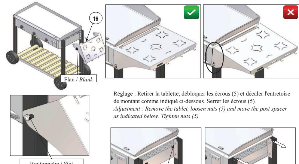
Réglage : Retirer la tablette, débloquer les écrous (5) et décaler l'entretoise de montant comme indiqué ci-dessous. Serrer les écrous (5).
